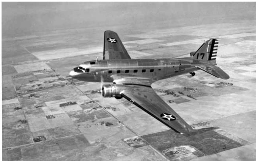
41. L'avion moderne, conçu pour réduire la résistance à l'air et augmenter la puissance ascensionnelle, est inspiré de l'étude des oiseaux et des poissons. À partir de 1920, le développement des connaissances scientifiques et des avancées techniques a été constant. Grâce à l'utilisation de nouveaux matériaux, tel le duralium, on put associer la force et la légèreté. L'avion a donné le ton en termes de perfectionnement et de précision techniques.
