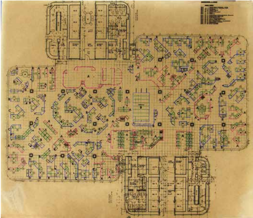
C'est l'absence de cloisons et de portes qui caractérise le bureau paysager. Projet d'aménagement des bureaux de la Dresdner Bank à Francfort-sur-le-Main [Allemagne]. Conception : Wieland Witt, Quickborner Team, 1978.
